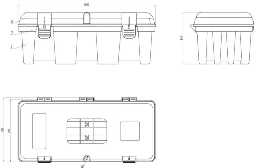
Рис. 1 Пластиковый пенал для огнетушителя "Partex"
