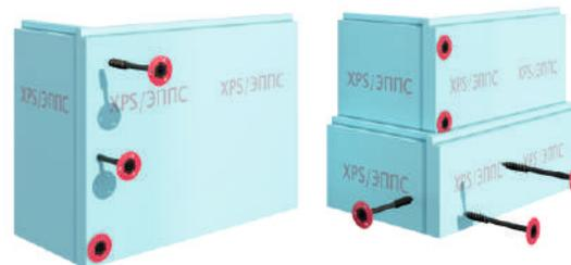
Торцевой стык плит теплоизоляции
