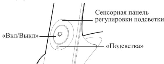
Включить, выключить лампу и отрегулировать яркость освещения можно при помощи кнопки «Вкл/Выкл»:
