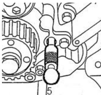
Рис. 5. Фиксация коленчатого вала при помощи приспособления 99360615.
