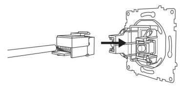
8. Вставить механизм розетки с присоединёнными кабелями в монтажную коробку в стене. Избегать перегибов и замятия проводов. (В случае необходимости удалить распорные лапки). Прижать металлическое опорное кольцо механизма к коробке и зафиксировать винтами, входящими в комплект коробки.
