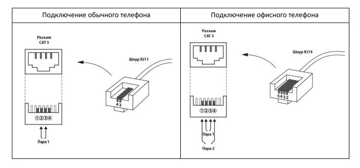
В обоих случаях, розетку можно будет использовать для подключения обычного аналогового телефона стандартным шнуром как с вилками RJ11, так и RJ14.
