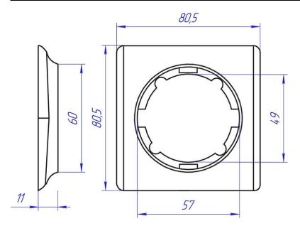
Модульные рамки на 2–5 приборов предназначены для горизонтальной установки. Модульная конструкция обеспечивает межосевое расстояние между приборами 71 мм.
