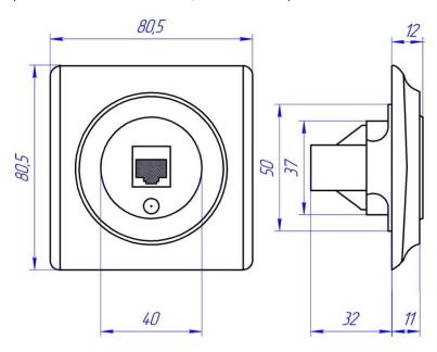
Розетка двойная телефон 1 х RJ14 + компьютер 1 х «RJ45», розетка двойная компьютерная 2 х «RJ45», (механизмы 1E2080130х, 1E2090130х):
