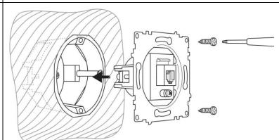
9. Если тип монтажной коробки не предусматривает крепёжных винтов, зафиксировать механизм распорными лапками, затянув винты по бокам фронтальной части механизма. Распорные лапки механизма не должны касаться или зажимать проводов во избежание повреждения их изоляции.
