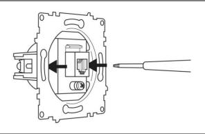
10. Наложить декоративную рамку, чтобы та плотно прилегала к опорному кольцу фронтальной части механизма и не имела зазоров со штукатуркой. Вставить в рамку лицевую накладку и затянуть её винтом.
