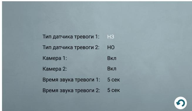
**Тип датчика тревоги 1,2** – выбор типа контакта подключенного датчика тревоги к разъему CAM1, CAM2. Когда срабатывает датчик, формируется сигнал тревоги, производится захват фото с тревожной видеокамеры. Одновременно с этим звучит звуковая сирена. Для выбора параметра доступны значения: HO (нормально-открытый), H3 (нормально-замкнутый) и «Выкл.».
