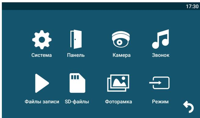
Для навигации по разделам меню используется вращение кнопки-колеса, а для входа в нужный раздел следует нажать на эту кнопку. В выбранном разделе нужный параметр можно выбрать нажатием на кнопку-колесо, а изменить значение – прокруткой.
