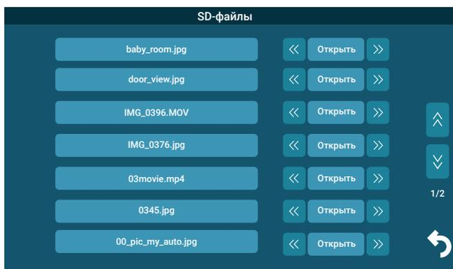
В этом разделе можно просмотреть все файлы, которые записаны на карту памяти microSD с помощью компьютера или прочего стороннего оборудования. Файлы, записанные самим монитором, здесь не отображаются. Монитор поддерживает воспроизведение видеофайлов в форматах avi и mp4, аудиофайлов в формате mp3, графических файлов в форматах jpg, png и bmp. Навигация, запуск и удаление файлов в этом разделе аналогичны этим же операциям раздела «Файлы записи» (см. выше).
