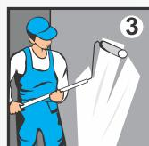
Грунт тщательно перемешайте до равномерного распределения кварцевого наполнителя и нанесите на основание валиком, кистью или щёткой тонким слоем, не допуская скопления излишков грунта на поверхности.
