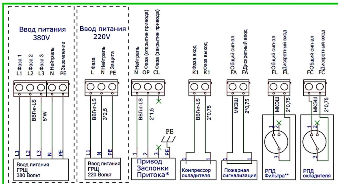
**С водяным нагревателем:****Node4 AC/EC W**
