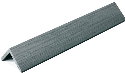
Торцевой уголок крепится к террасной доске с использованием самореза или на жидкие гвозди. В случае если Торцевой уголок будет монтироваться с использованием саморезов, то требуется предварительно просверлить в Уголке отверстие на 1-1,2 мм больше, чем диаметр самореза.
