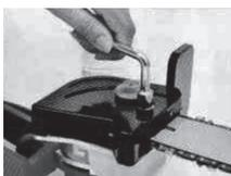
**Шаг третий:** затяните гайку гаечным ключом и смажьте цепь.
