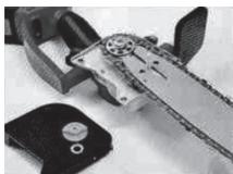
**Шаг первый:** снимите верхнюю крышку корпуса, наденьте цепь на шину, затем на звездочку и установите шину на направляющий элемент.
