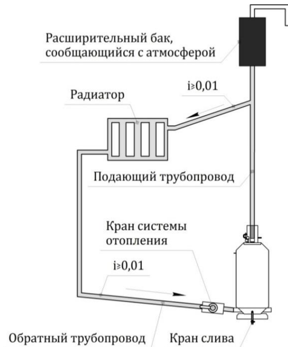
Рисунок 8 – Схема открытой системы отопления с естественной циркуляцией
