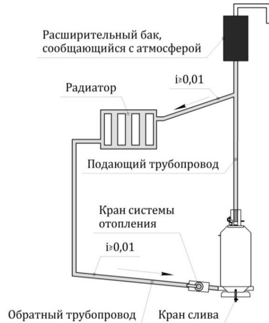
Рисунок 8 – Схема открытой системы отопления с естественной циркуляцией
