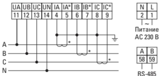
Рисунок 5 – Схема подключения приборов SM-B-96, SM-B-72
