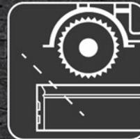
При углах не равных 90 градусам, использовать торцовочную пилу. Пильный диск должен иметь максимальное число зубьев (диск для резки алюминия). Выставить необходимый угол и произвести запил.
