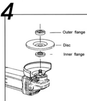
4. Нажмите кнопку стопора вала, слегка проверните приводной вал до фиксации. Затяните наружный фланец при помощи ключа для наружного фланца (Рис.5).
