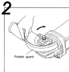
Установите защитный кожух так, чтобы исключался выброс искр в направлении оператора.
