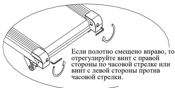
Если полотно смещено влево, то отрегулируйте винт с левой стороны по часовой стрелке или винт с правой стороны против часовой стрелки.
