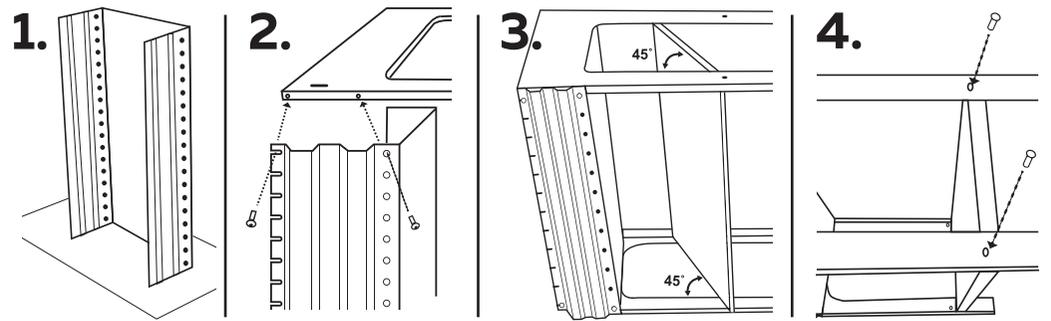
1. Поставьте корпус мангала вертикально на ровную стационарную поверхность. 2. Присоедините сначала одну ножку к корпусу при помощи 4 гаек и 4 болтов (2 с каждой стороны) Затем присоедините 2 ножки. 3.-4. Далее при помощи 4 болтов и 4 гаек (2 на каждую сторону) присоедините нижнюю полку к ножкам мангала. Нижнюю полку мангала рекомендовано вставлять под углом 45 градусов.
