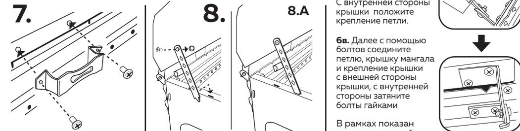
7. Присоедините с помощью 2 гаек и 2 болтов ручку к крышке мангала 8. Прикрепите упор крышки к боковой стенке крышки 8а. Далее с помощью болтов соедините петлю, крышку мангала и крепление крышки с внешней стороны крышки, с внутренней стороны затяните болты гайками
