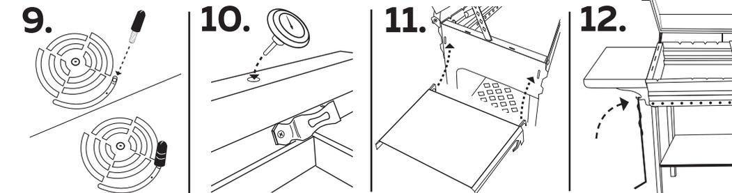
9. Присоедините ручку вентиляционного окна 10. Присоедините термометр к крышке 11. Прикрепите боковые полки к мангалу 12. На крючки боковых полок повесьте кочергу и лопатку
