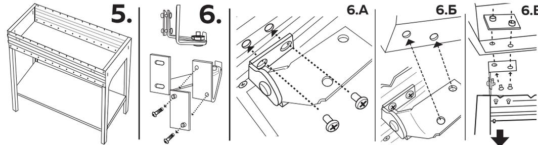
5. Поставьте мангал на ножки 6. Прикрепите крышку мангала к корпусу мангала. Для этого отсоедините крепление петли от петли. 6а. Далее прикрепите петли к задней части корпуса мангала как это показано на рисунке 6б. Положите крышку мангала на петли. Прорези на петле и крышке должны совпасть. С внутренней стороны крышки положите крепление петли.
