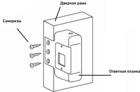
Вариант №2. Крепление снаружи дверной рамы.
