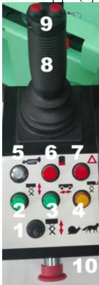
Рис 9 - Пульт управления на рабочей платформе (верхний пульт)**
