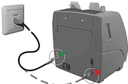
В счётчике необходимо настроить параметры локальной сети. Нажмите клавишу **Ethernet** (Ethernet), в подменю «Дополнит.» (см. Рис. 24), откроется окно конфигурации сети (см. Рис. 23б). В этом окне необходимо ввести ip-адрес счётчика (address), маску подсети (Mask) и шлюз (Gateway). Эти настройки вводит администратор локальной сети в соответствии с правилами, принятыми в сети.
