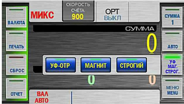
В режиме «СЧЁТ» нажатие на клавишу вызывает всплывающее меню (поверх главного экрана), в котором можно включить/отключить проверки **УФ-просвет**, **Плотность** (см. Рис. 54). Для выбранной темы интерфейса включенная проверка будет подсвечена синим цветом (см. Рис. 51), выключенная – серым:
