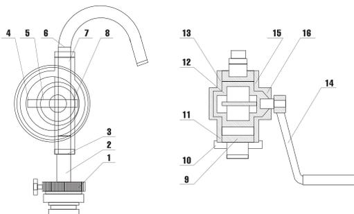
1 – гайка с фиксатором; 2 – труба для набора и слива жидкости; 3, 7 – фиксированные контргайки; 4 – подвижные пластины; 5 – пружина; 6 – выпускной патрубок (гусак); 8 – стержень; 9 – корпус; 10 – болт; 11 – уплотнительные кольца; 12 – ротор; 13, 15 – крышки; 16 – манжеты
