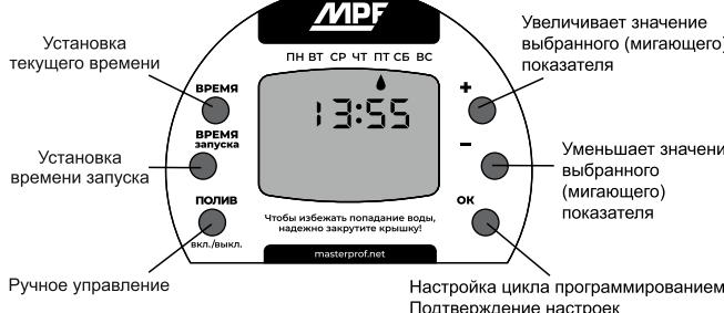
Максимальное рабочее давление: 80 фунтов на кв. дюйм Только для полива
