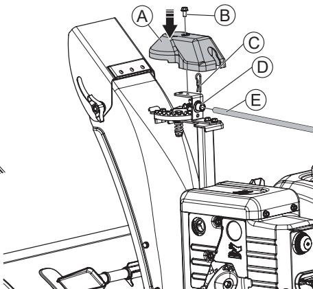
Проденьте рукоятку поворота желоба (A) через хомут (B) нижней рукоятки и установите её в отверстие рулевого механизма, зафиксируйте штифтом. Установите декоративную крышку (A) и зафиксируйте ее. Используйте крепеж: (B) болт M6×12 – 1 шт.; (C) сплинт – 1 шт.
