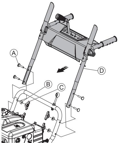
Совместите отверстия нижней и верхней рукояток, и закрепите при помощи болтов и пластиковых барашковых гаек. Используйте крепёжные элементы: (А) болт M8x50 – 4шт.; (В) фигурная шайба – 4 шт.; (С) барашковая гайка M8 – 3 шт. Затяните болты от руки. Закрепите трос привода шнеков.
