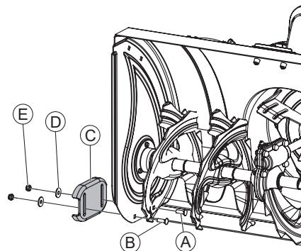
Для предохранения от повреждений частей ковша снегоуборочной машины установите башмаки по его обеим сторонам. Используйте детали крепежа: (A) болт M8×25 – 2 шт.; (B) болт M8×20 – 2 шт.; (D) гроверная шайба D8 – 4 шт.; (E) Гайка M8 – 4 шт.
