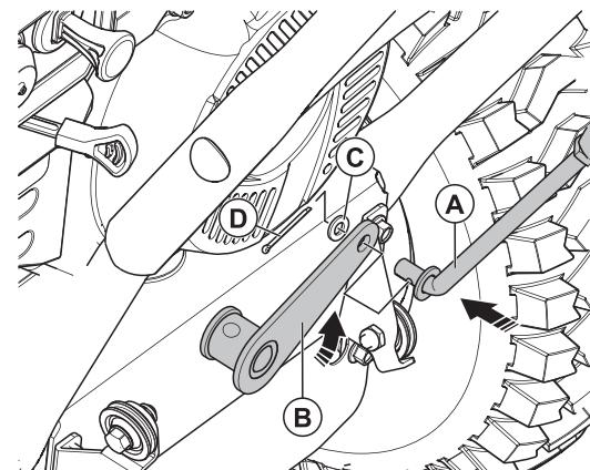
Установите на снегоуборочной машине в отверстие коннектора (B) тягу (A) и закрепите, используйте крепежные элементы: (C) шайба - 1 шт.; (D) шплинт - 1 шт.
