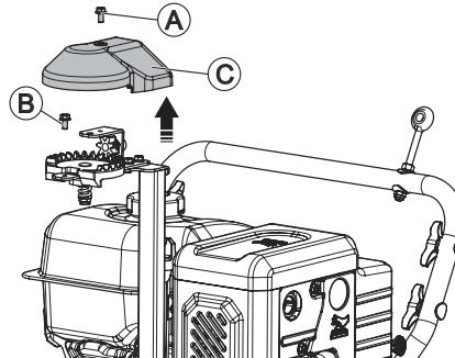
Снимите верхнюю крышку, установите и закрепите поворотный желоб используя крепеж: (A) болт M8x16 – 1 шт.
