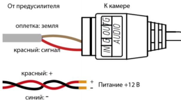
Назначение контактов с выхода микрофонного предусилителя.
