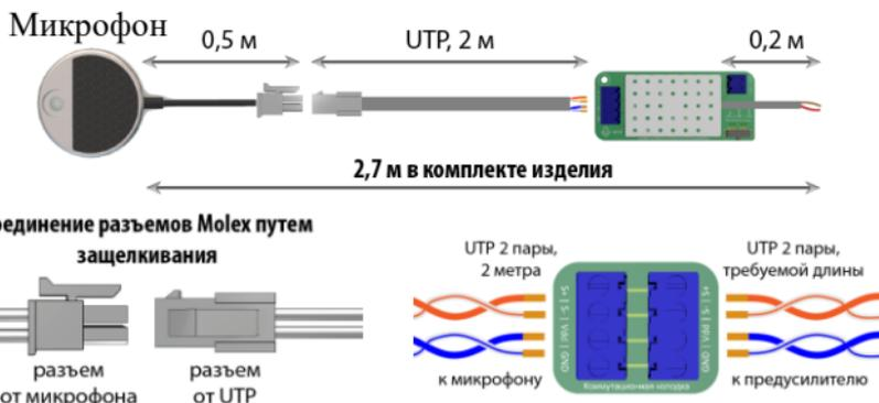
Если не хватает длины для соединения микрофона с входной клеммной колодкой микрофонного ПУ, воспользуйтесь клеммником - коммутационной колодкой, с помощью которой можно соединить два провода UTP требуемой длины.
