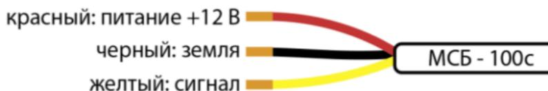
Рис. 1 – Назначение контактов микрофона
