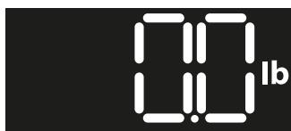
2. Нажмите кнопку ЕДИНИЦА ИЗМЕРЕНИЯ на задней панели шкалы, чтобы выбрать нужную единицу измерения (kg or lb)
