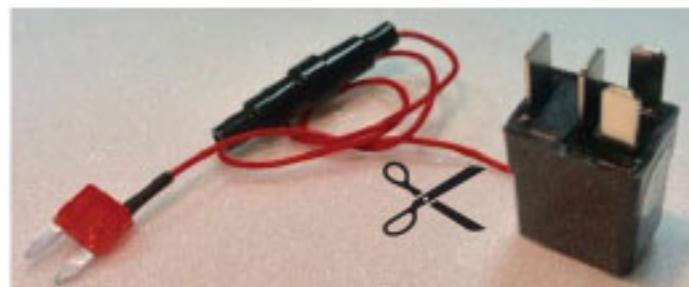
Если Вы не планируете использовать красный провод для подключения к постоянному питания +12V, просто откусите его для обеспечения повышенной секретности установки реле-иммобилайзера. От подключения или отсутствия красного провода зависит только время задержки включения и выключения режима охраны.
