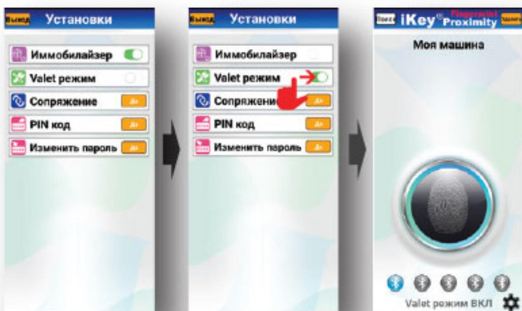
**Важно!** Если в момент включения зажигания в пределах зоны связи канала Bluetooth окажется несколько смартфонов, сопряженных с иммобилайзером, иммобилайзер может первыми принять настройки со смартфона, в меню «Установки» которого режим Valet не был включен. Это обусловлено принципом работы канала Bluetooth (one-to-one),
