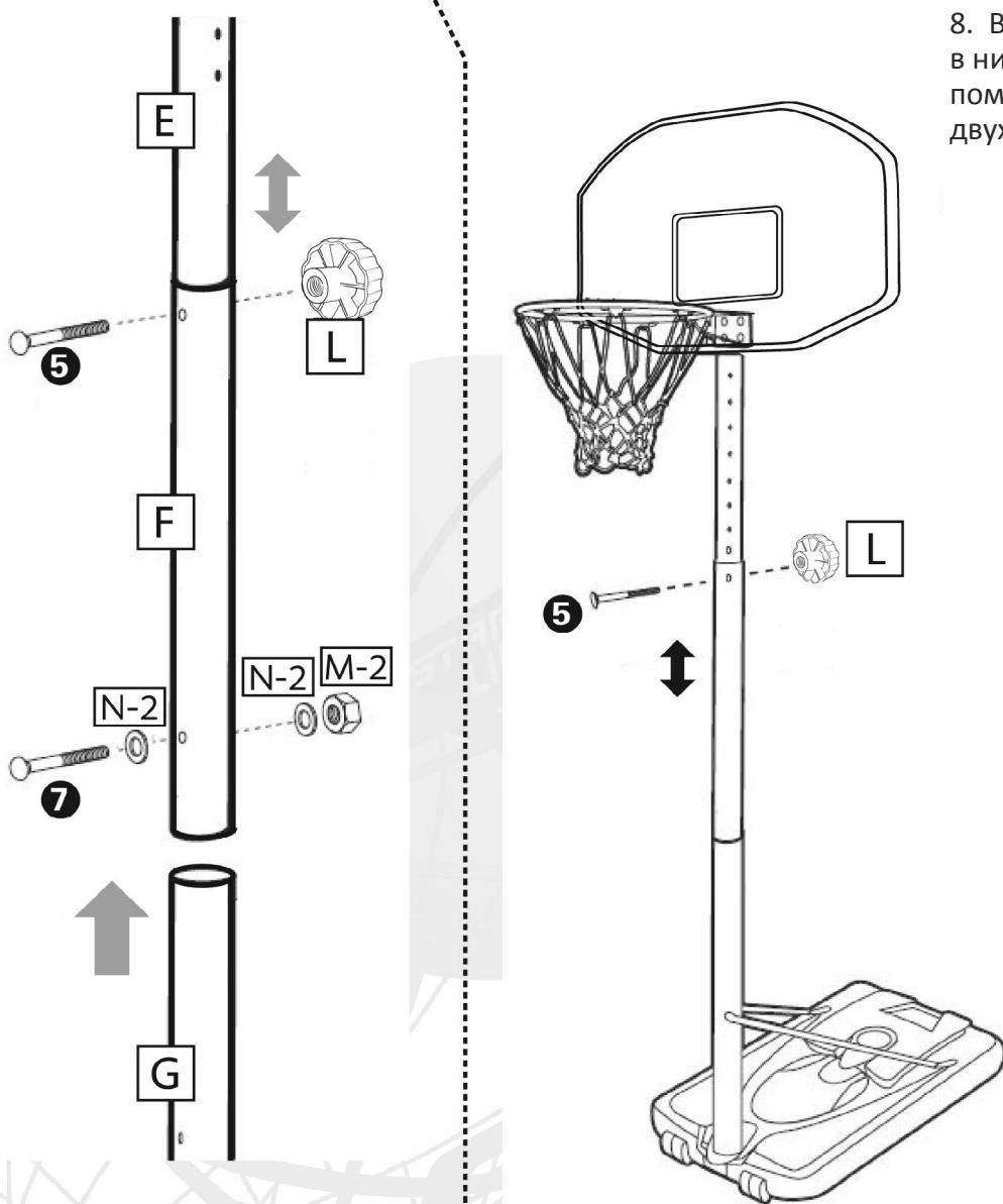
8. Вставьте среднюю стойку в нижнюю стойку, скрепите с помощью болта (5), двух шайб (N-2) и гайки(M-2).
