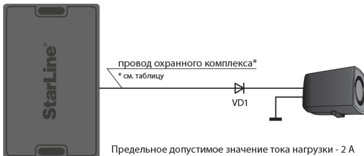
Схема подключения автомобильной сирены
