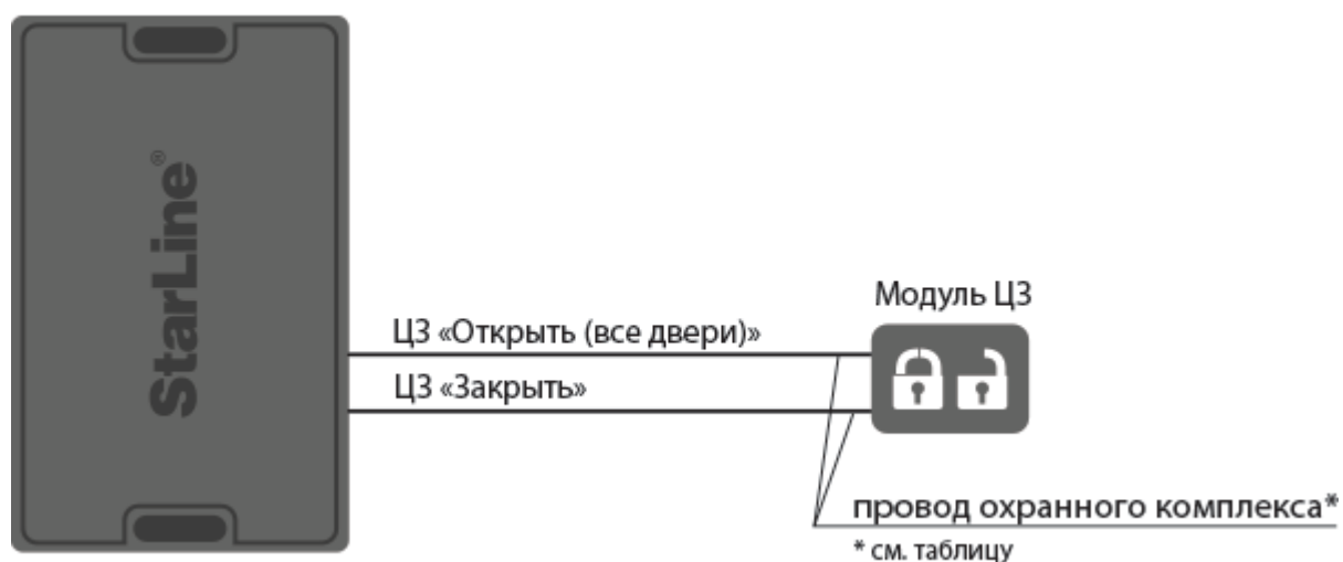
Схема аналогового подключения центрального замка для охранных комплексов StarLine E96/E66, S96/S66, M96, X96 (v2)
