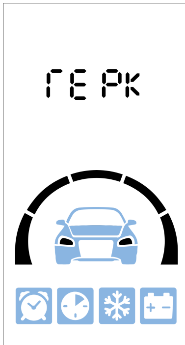
Рис. 1. Индикация при нарушении зоны BLE-геркона на брелоке с вертикальным дисплеем
