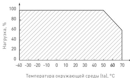
Рис. 2. Максимальная допустимая нагрузка, % от мощности источника
