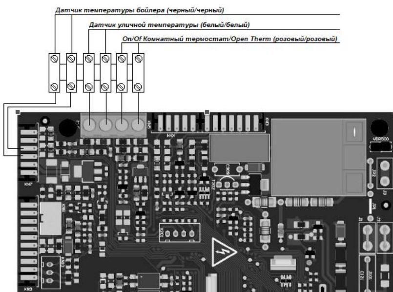
Датчик бойлера в комплект поставки не входит. Длина кабеля датчика температуры водонагревателя не должна превышать 3 метра. В противном случае, следует использовать экранированный кабель.
