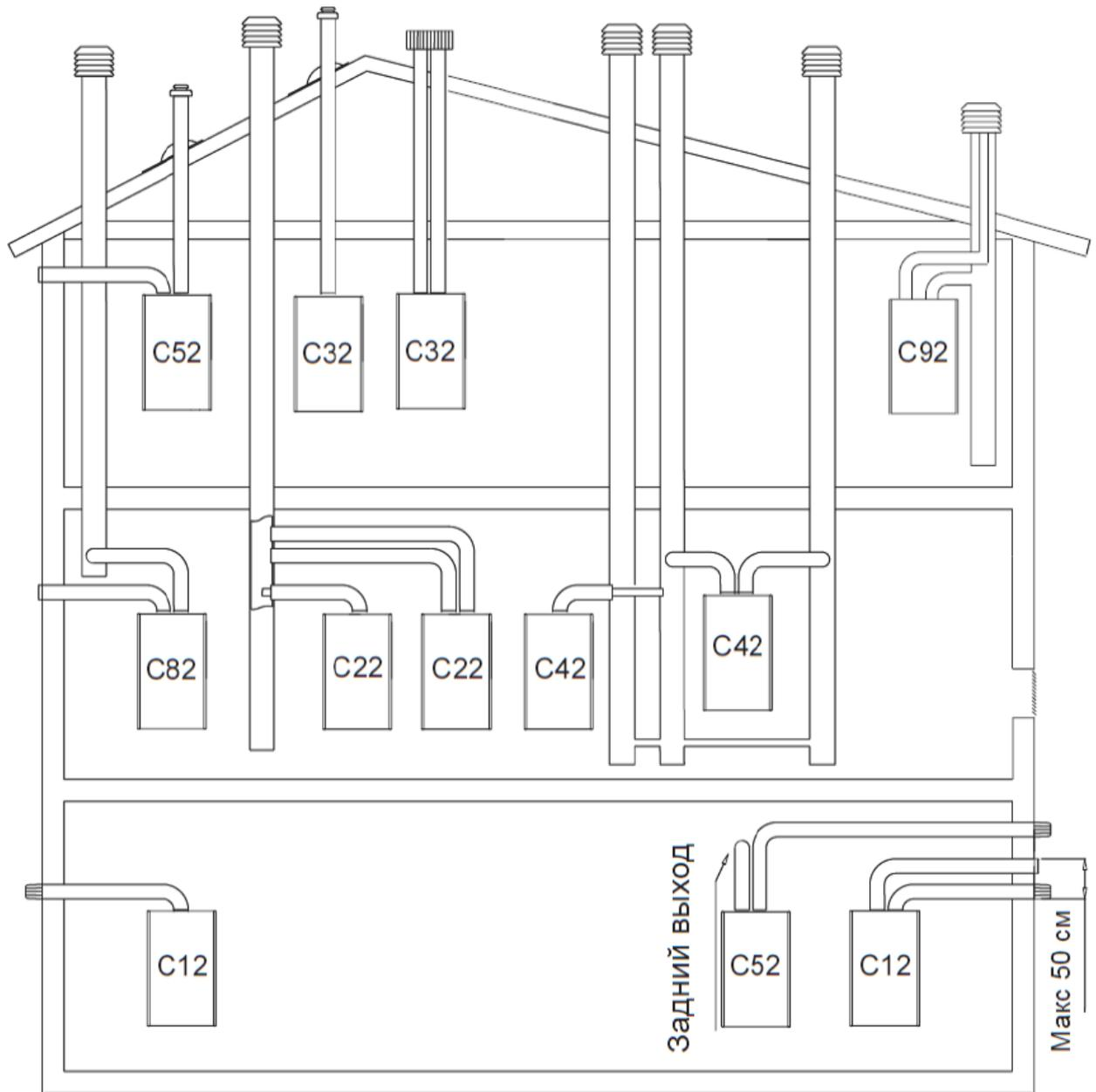
**C12-C12x** Выход дымовых газов через коаксиальные дымоотводы/воздуховоды. Дымоотводы и воздуховоды могут быть отдельными или коаксиальными. В случае использования отдельных дымоотводов/воздуховодов их выходы наружу должны быть расположены достаточно близко, чтобы находиться в одинаковых ветровых условиях
