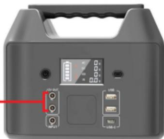
**Внимание!** выходное напряжение 12В постоянного тока находится в диапазоне от 9 В до 12,6 В, максимальный суммарный выходной ток обоих выходов составляет 10А. Выходное напряжение постоянного тока падает, когда емкость аккумулятора падает из-за химических характеристик аккумуляторной батареи. Если ваш прибор DC 12В не имеет встроенной функции стабилизации входного напряжения, он может отключиться, когда входное напряжение слишком низкое, пожалуйста, вовремя отключите прибор от устройства.
