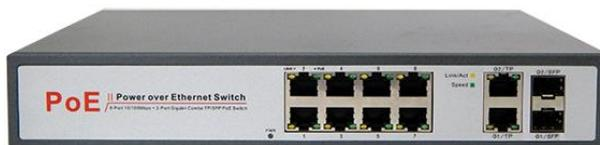
PoE-коммутатор для CCTV. 8xRJ45 PoE 10/100 до 30Вт и 2xRJ45 Uplink 10/100/1000. 2xSFP 10/100/1000 (совмещенные с 2xRJ45). Неуправляемый. Производительность до 5,6Gbps / 4,2Mpps. Store-And-Forward, Auto-negotiation, Flow Control, Full duplex. Бюджет PoE до 120Вт. Питание AC 220В / 50Гц (встроенный блок питания). Температурный диапазон -20°C ~ +55°C, вес 1710г, размеры 270x181x44мм. Металлический 10,6" кожух (в комплекте 19" скобы, кабель питания 220В)
