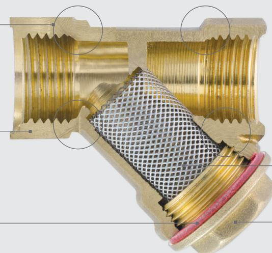
Y-образные фильтры монтируются как в горизонтальном, так и в вертикальном положении крышкой ревизии вниз. Стрелка на корпусе фильтра должна совпадать с направлением потока фильтруемой среды.
