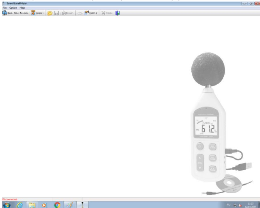
Для соединения с устройством кликните по кнопке «Real Time Measure».
