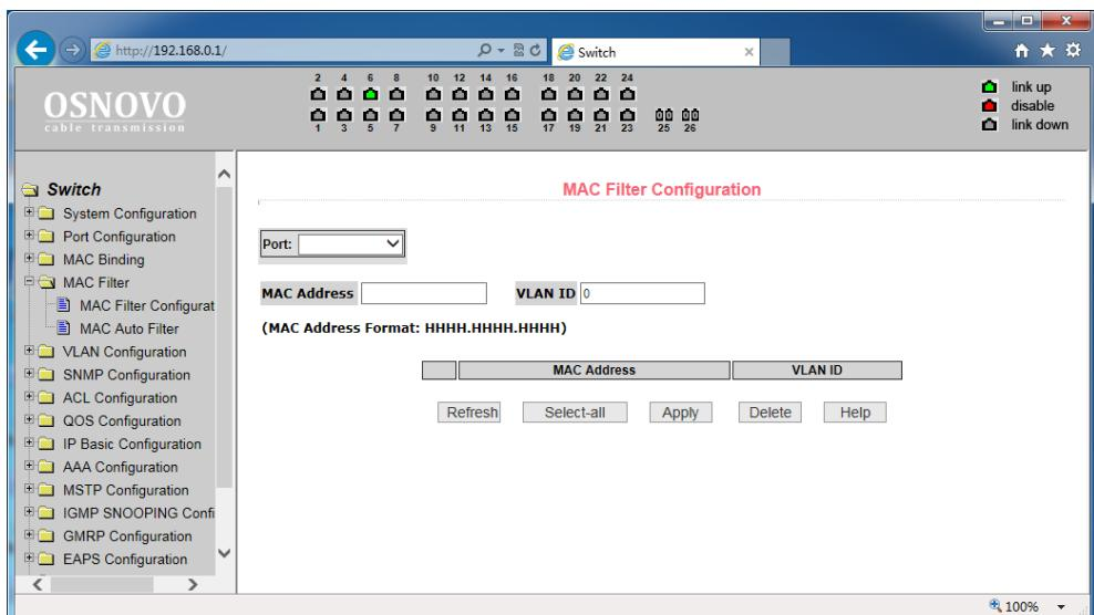
Настройки на этой странице позволяют фильтрацию MAC адресов для портов. Записи с MAC адресами на этой странице используются для входа в фильтр MAC адресов, а VLAN ID используется для фильтрации MAC адреса соответствующей VLAN.
