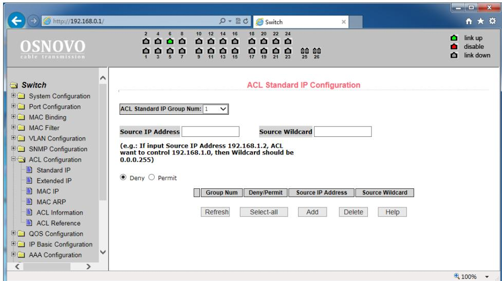
Здесь представлены настройки ACL для IP протокола. Пользователь может задать самостоятельно ACL базу с правилами для IP адресов. Стандартные правила контролируют перенаправление исходных IP пакетов.
