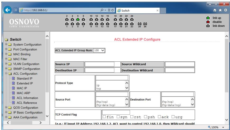
Здесь представлена возможность для создания ACL правил с расширенными настройками IP адресов. Контроль пересылки пакетов через исходный IP адрес, адрес назначения, тип протокола, служебный порт.
