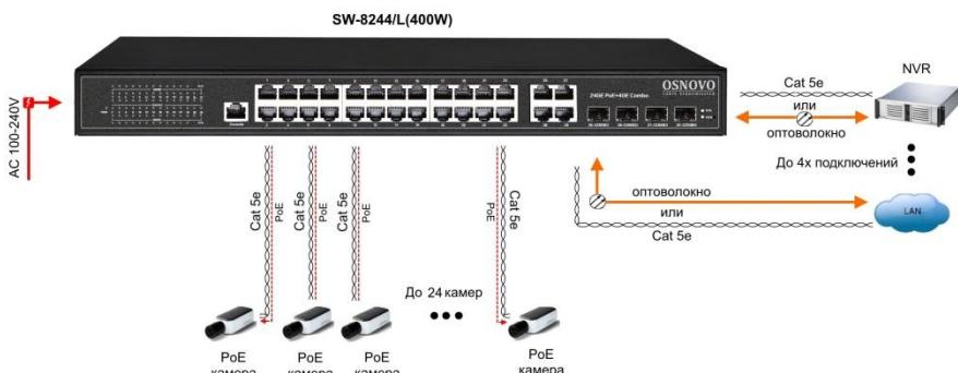
Рис.8 Типовая схема подключения коммутатора SW-8244/L(400W)
