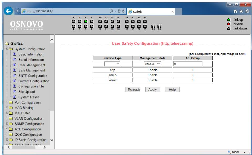
На данной странице находятся настройки, позволяющие администратору гибко управлять доступом к управлению коммутатором (WEB, TELNET или SNMP) на основе ACL (лист управления доступом)
