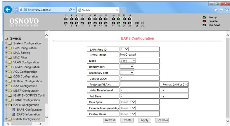
На данной странице WEB интерфейса представлены настройки протокола EAPS (Ethernet Automatic Protection Switching), предназначенного для защиты от петель в сети.
