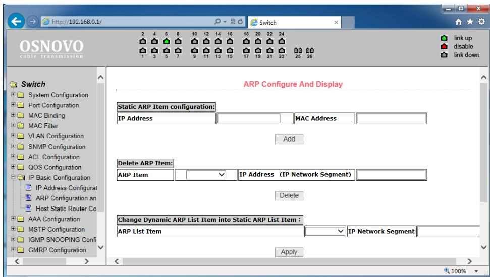
Страница настроек ARP предоставляет возможность отображать всю таблицу ARP коммутатора, менять Static ARP, удалять ARP, менять Dynamic ARP на Static ARP.
