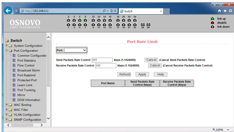
На данной странице можно гибко ограничивать скорость приема/передачи пакетов на выбранном порте. Для этого выберите порт в выпадающем списке PORT, а затем укажите значение в Кбит/с для скорости передачи данных (Send Packets Rate Control) и для скорости приема данных (Receive Packets Rate Control). Для применения настроек нажмите кнопку Apply (принять). Для отмены ограничения пропускной способности нажмите кнопку Cancel (отмена).
