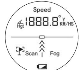
В приборе режим работы и результат измерений выводится на ЖК-дисплей, который проектируется на оптический видоискатель.
