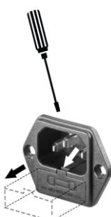
**ЗАПРЕЩАЕТСЯ** устанавливать предохранитель большего номинала или перемычку возможно возгорание прибора или повреждение электросетей. В случае нарушения производитель не несёт ответственности.
