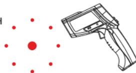
Диаметр круга приблизительно соответствует диаметру пятна измерения.
