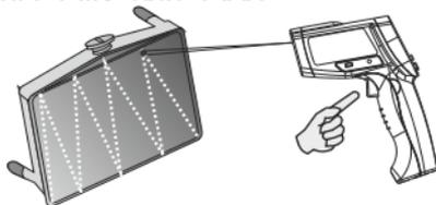
по площади с учётом времени измерения (примерно 2 измерения в секунду). Во время измерения прибор на основном поле дисплея будет отображать текущую температуру, а в дополнительном поле максимальную или минимальную зафиксированную температуру.
