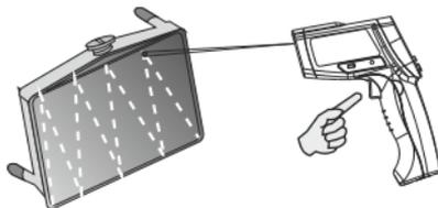
для подтверждения. Нажмите и, удерживая курок, ориентируясь на целеуказатель, зафиксируйте прибор в нужной точке или медленно перемещайте по площади с учётом времени измерения (примерно 2 измерения в секунду). Во время измерения прибор на основном поле дисплея будет отображать текущую температуру, а в дополнительном поле среднюю из зафиксированных значений.
