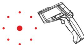
Диаметр круга приблизительно соответствует диаметру пятна измерения.
