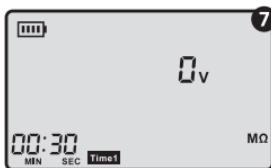
● Нажмите кнопку «Измерение» и поверните по часовой стрелке до блокировки и отпустите её. Прибор начнет измерять сопротивление, и вести обратный отсчёт времени. Будет звучать прерывистый звуковой сигнал, а значок таймера «TIME1» будет мигать, дисплей будет выглядеть как на картинке: 8
