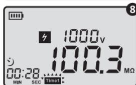
● По окончании установленного времени прибор завершит измерение автоматически. Значок высокого напряжения исчезнет, а звуковой сигнал прекратится. Поверните кнопку «Измерение» проверки против часовой стрелки и верните её в исходное положение. На дисплее будет отображено: время измерения и измеренное значение сопротивления, как на картинке: 9
