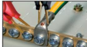
**⚠ Перед измерением сопротивления необходимо убедиться в отсутствии напряжения на измеряемом компоненте или участке цепи. Недопустима подача любого напряжения на любые гнёзда прибора.**
