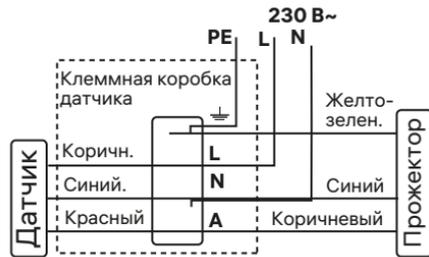
Схема подключения 25830 8
