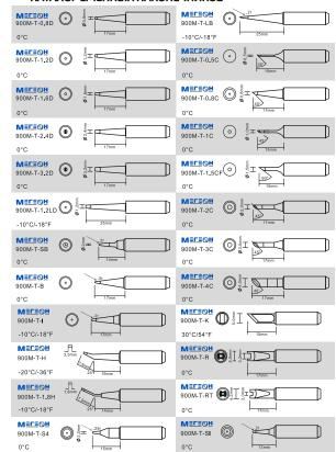
**ОБРАТИТЕ ВНИМАНИЕ!!!** При установке различных наконечников, необходима коррекция температуры, это связано с различной формой, сечением и размером наконечника.
