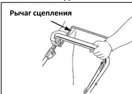
Для модели **RD-GLM42S** отпустите рычаг сцепления. Движение газонокосилки прекратится.
