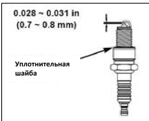
Измерьте зазор электрода свечи зажигания соответствующим прибором. Зазор должен составлять 0,028-0,031 дюйма (0,7 ~ 0,8 мм). Исправьте зазор, если необходимо, путем тщательного изгиба бокового электрода с помощью необходимого инструмента.
