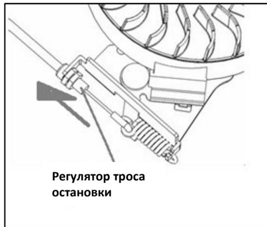
Если рычаг сцепления ослаблен, необходимо повернуть регулятор тросика сцепления, чтобы натянуть его. (См. рисунок).
