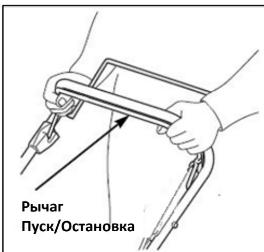
Встаньте за газонокосилкой. При запуске двигателя прижмите рычаг пуска/остановки двигателя к рукоятке управления.
