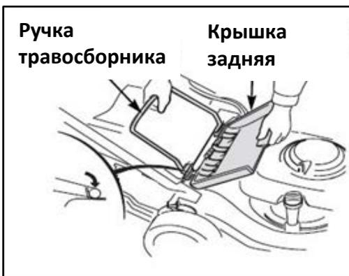
Поднимите защитную крышку заднего желоба выброса, удалите заглушку для мульчирования и установите травосборник.
