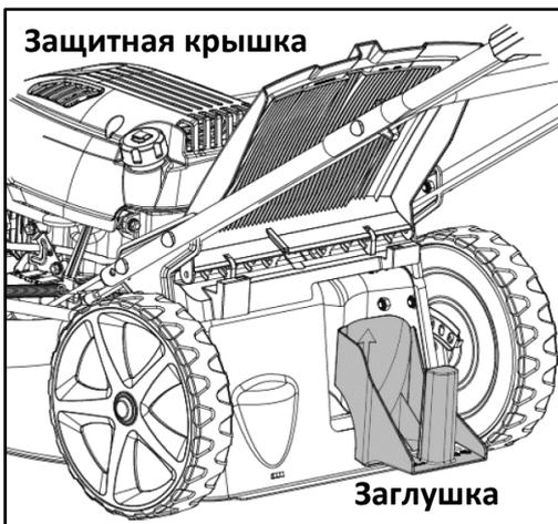
Заглушка для мульчирования позволяет использовать место внутри деки косилки для более эффективного измельчения травы. Чтобы установить/снять заглушку для мульчирования, поднимите защитную крышку заднего желоба выброса, как показано на рисунке. Заглушка для мульчирования подходит только в одном направлении. Уберите заглушку для мульчирования при использовании травосборника.
