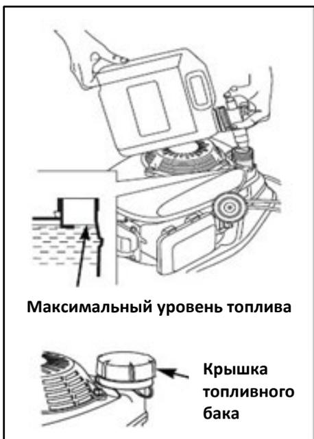
Заправьте 0,8л (**RD-GLM40P**) или 1,0 л (**RD-GLM42 (42S)**) бензина перед запуском двигателя. Для заправки используйте только чистый неэтилированный бензин с октановым числом не ниже 92.
