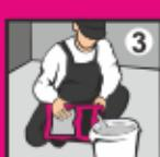
Для подготовки раствора залейте водопроводную воду комнатной температуры в чистую ёмкость из расчёта 10,5 - 11,5 л воды на 1 мешок (30кг).
