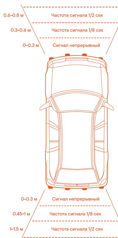
При движении вперед передние сенсоры работают после нажатия на педаль тормоза некоторое время, затем отключаются. Это позволяет пользоваться парковочным радаром при парковке. При обычной езде устройство отключается автоматически.
