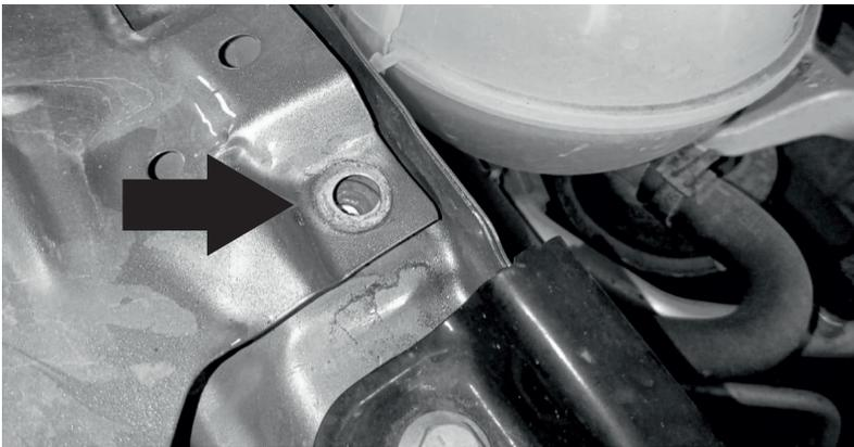
Выкрутить болт крепления крыла.
