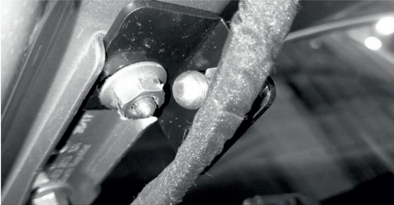
Открутить верхний болт крепления крышки капота. Установить кронштейн как показано на фото; зафиксировать кронштейн болтом. Вставить и зафиксировать в кронштейне болт-шарнир М8, как на фото (шарниром внутрь).
