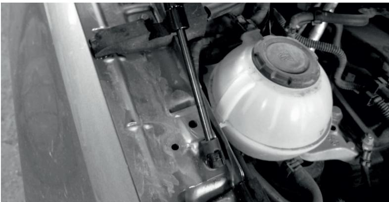
Установить упор, защёлкнув фитинги на шарниры (Упоры устанавливаются **ОБЯЗАТЕЛЬНО** штоком вниз). Аналогично установить крепление и упор на другую сторону. Проверить сохранение зазоров между упорами и крыльями.
